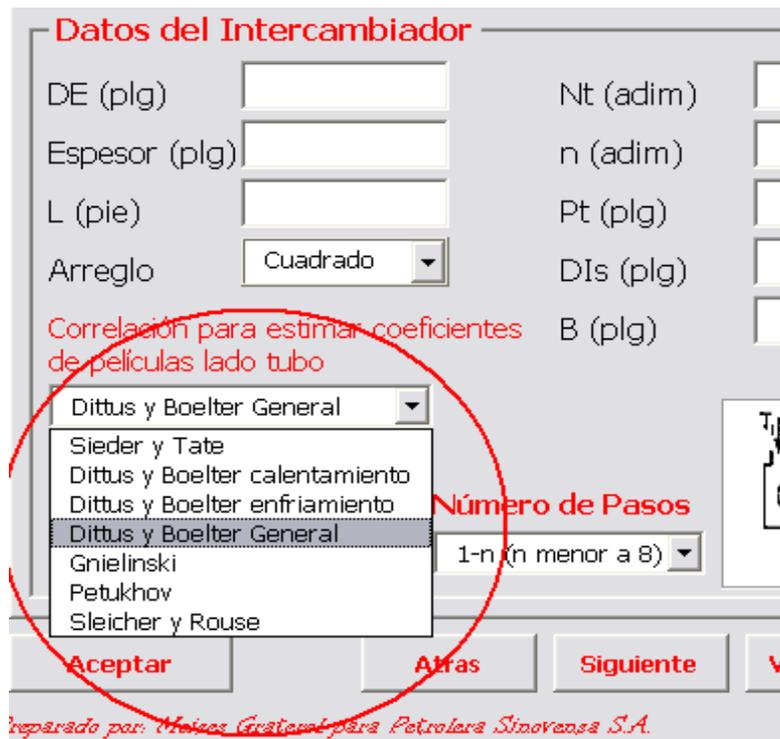
**Figura 25** Lista de correlaciones usadas en la aplicación para calcular coeficientes individuales de transferencia de calor
