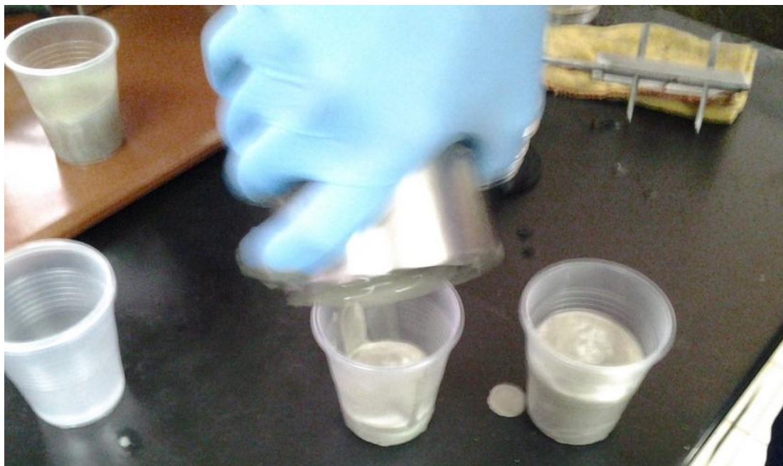
Figura 3.5 Lechada en Consistómetro Presurizado
