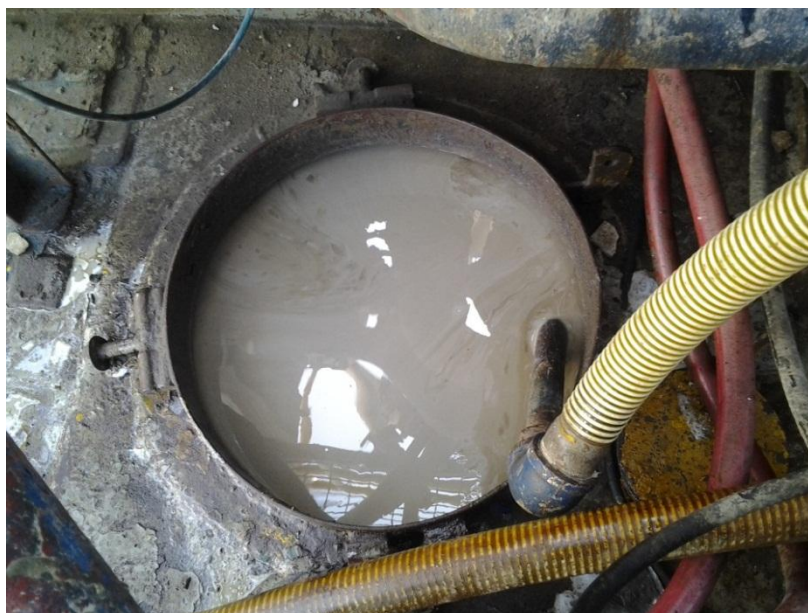
Figura 3.11 Entrada al tanque con los retornos fraguados
