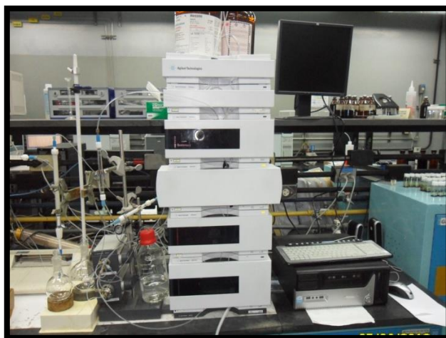
Figura 3.7: Equipo HPLC para realizar la separación de las fracciones de maltenos.
