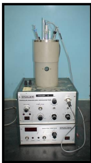
Figura 3.6: Osmómetro crioscópico utilizado para medir el peso molecular de los solventes.
