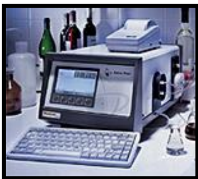
Figura 3.3: Densímetro digital utilizado para medir la densidad y gravedad API.
