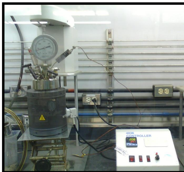
Figura 3.10: Montaje de las pruebas de compatibilidad crudo-solvente en estático.
