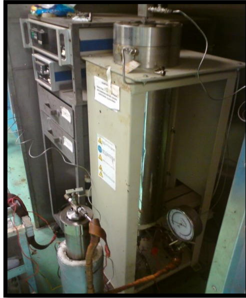
Figura 3.14: Reactor por carga usado para recombinar el crudo muerto deshidratado [62] .
