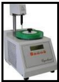
Figura 3.5: Osmómetro de presión de vapor utilizado para medir el peso molecular del crudo muerto deshidratado.
