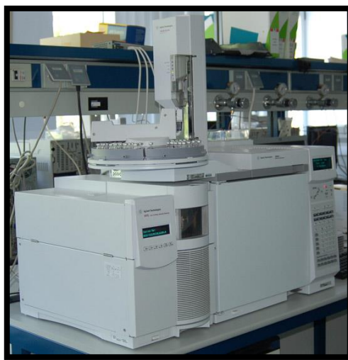
Figura 3.8: Cromatógrafo de gas con columna pre-empacada.
