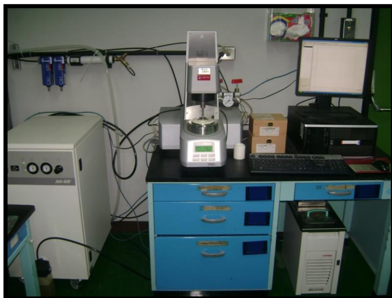
Figura 3.4: Reómetro rotacional y sus equipos auxiliares.
