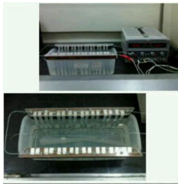
Figura N° 7 Sistema de anodizado Fuente: La autora.
