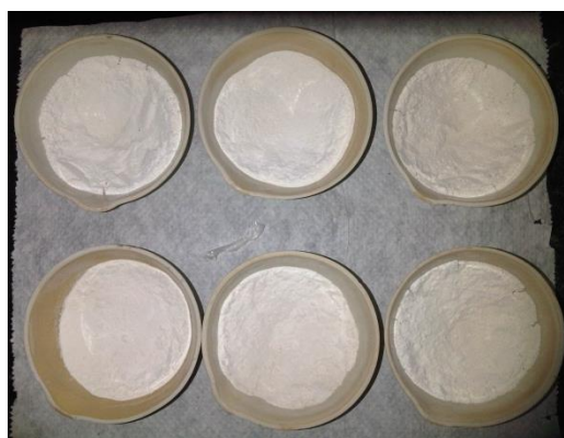
Figura N° 9. Alúmina sintetizada a partir de Isopropóxido de aluminio y fructosa
