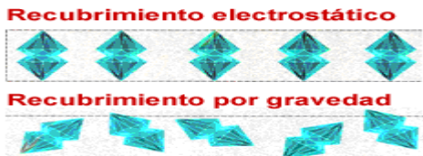
Figura N°. 5. Esquema de la disposición del mineral abrasivo por gravedad o por interacciones electrostáticas.
