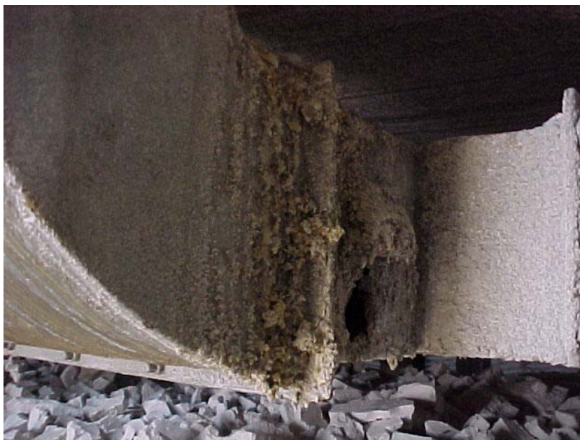
Figura N° 5.13 Orificio en el codo del difusor
