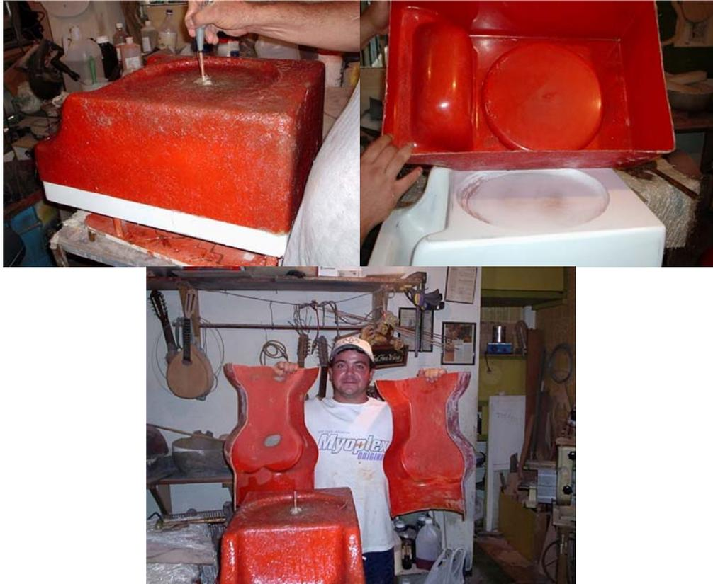
Fig. 5.5: Desmolde del negativo.
