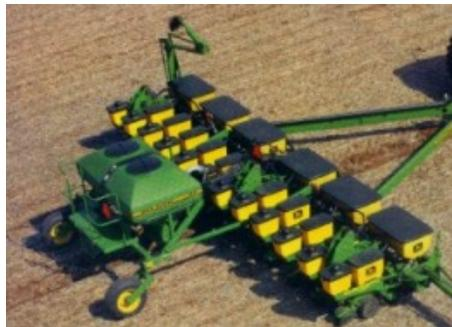
Fig. 1.9 Sembradora AIR-DRILL con dosificación de semillas y fertilizante.
