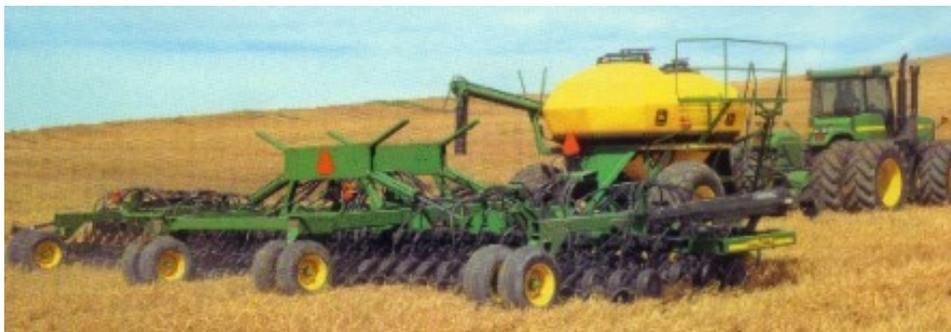
Fig. 1.10 Sembradora AIR-DRILL con dosificador de fertilizante.
