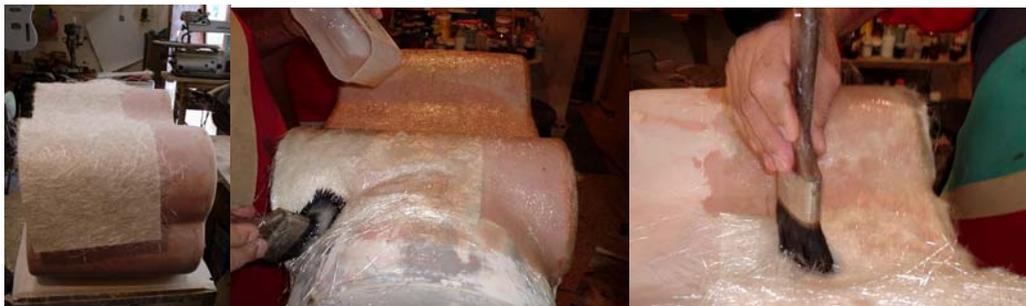
Fig. 5.4: Pintura desmoldante y aplicación de fibra de vidrio.
