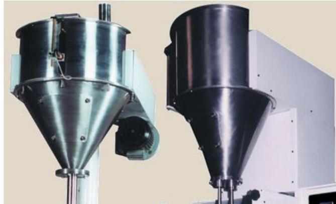
Fig. 1.12 Dosificador a tornillo sin-fin
