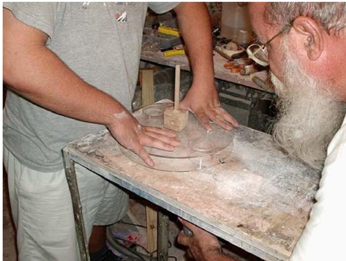
Fig. 5.7: Elaboración en acrílico del revolver dosificador.
