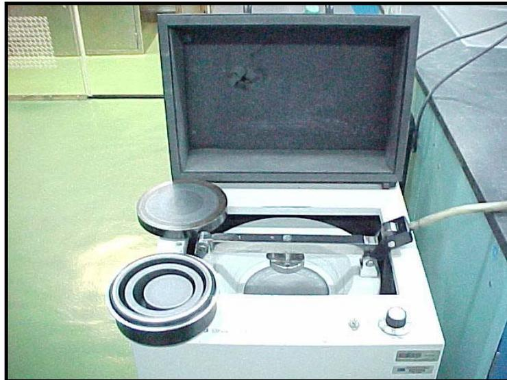
Fig. 8. Molino pulverizador de muestras, marca *Shatterbox* modelos: 8500-115/ 8500.
