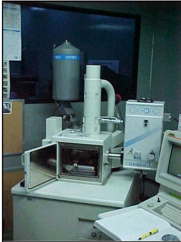
Fig. 16. Microscopio electrónico JSM-5800 LV.
