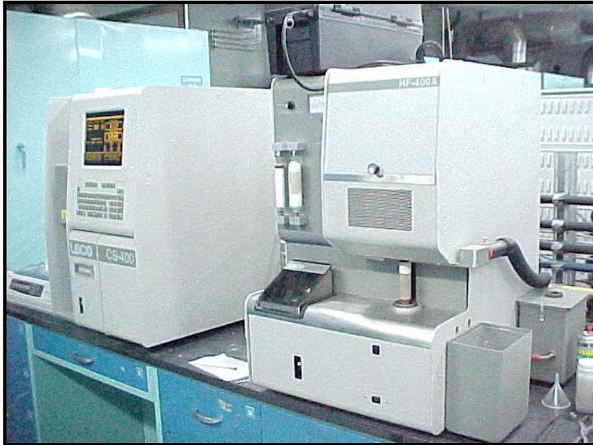
Fig. 10. Estación de trabajo para determinar automáticamente los valores de COT y  $\text{CaCO}_3$ .
