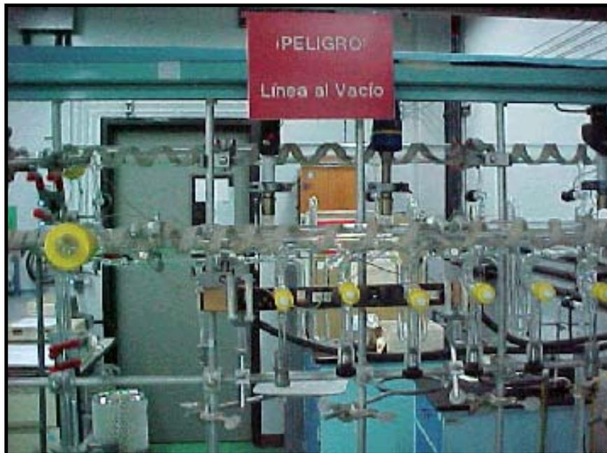
Fig. 12. Línea de Vacío donde se coloca el tubo de reacción para la generación de CO<sub>2</sub>.
