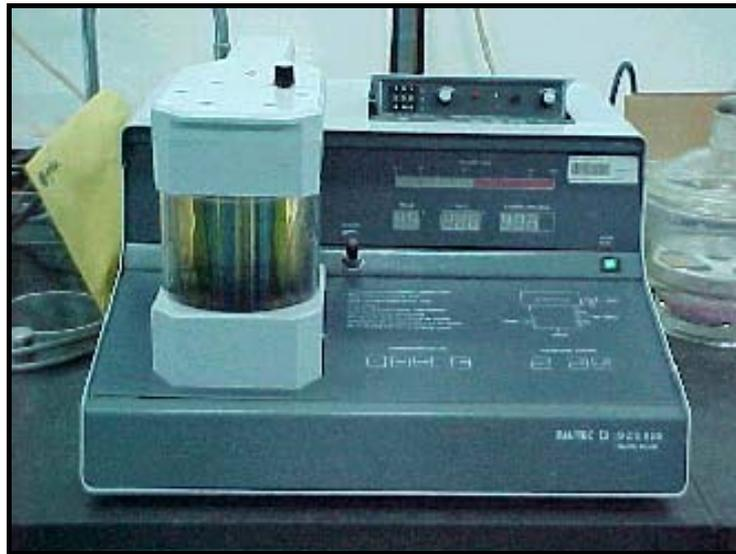
Fig. 17. Recubridor de carbono *Bal – Tec SCD050*.
