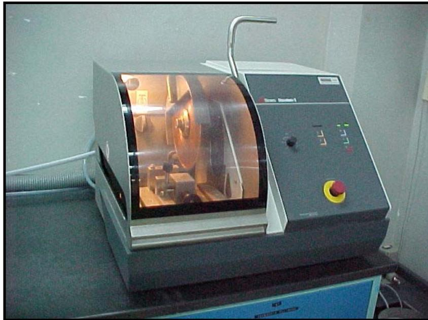
Fig. 3. Cortadora de Rocas para obtener los tacos para hacer las secciones finas.
