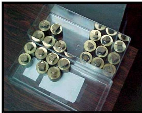
Fig. 15. Tacos de fracción de rocas para el estudio de electrones secundarios “SE” en la microscopía electrónica.
