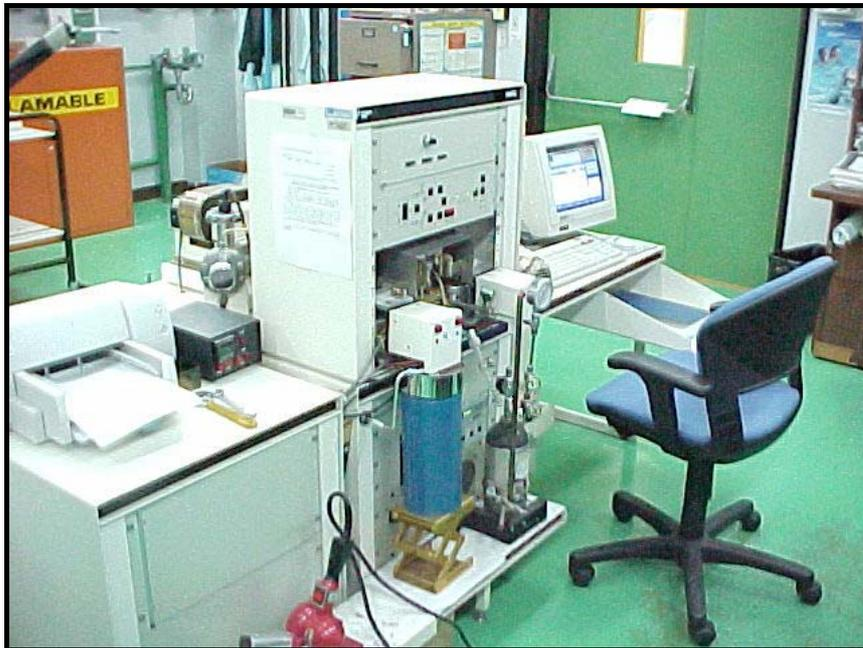
Fig. 14. Espectrómetro de masas para medir las relaciones isotópicas de carbono y oxígeno.
