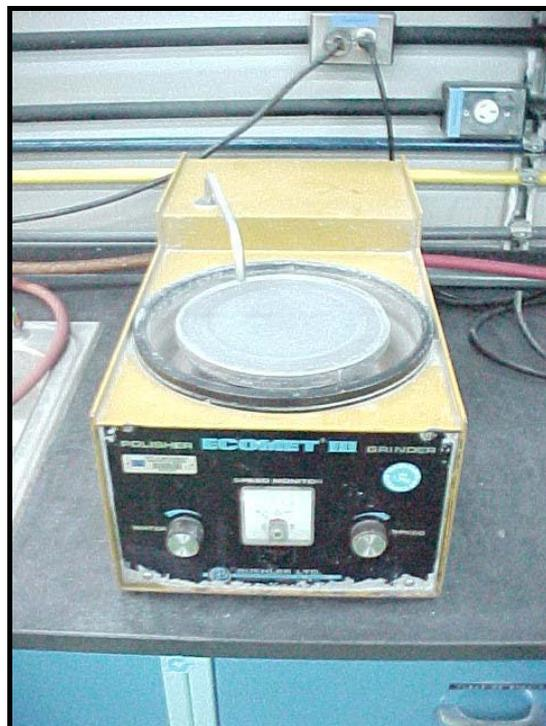
Fig. 4. Lijadora de muestras marca *Ecomet*, modelo *III* para obtener la superficie plana del taco de roca.
