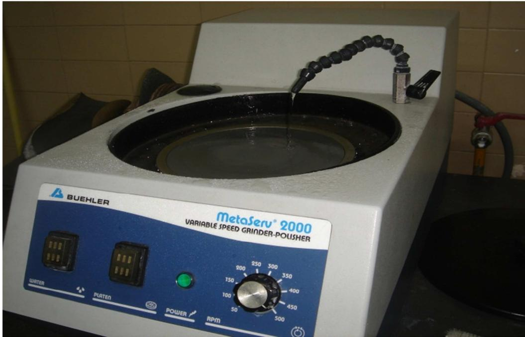
**Fig. 10** Equipo para desbaste Marca BEUHLER
