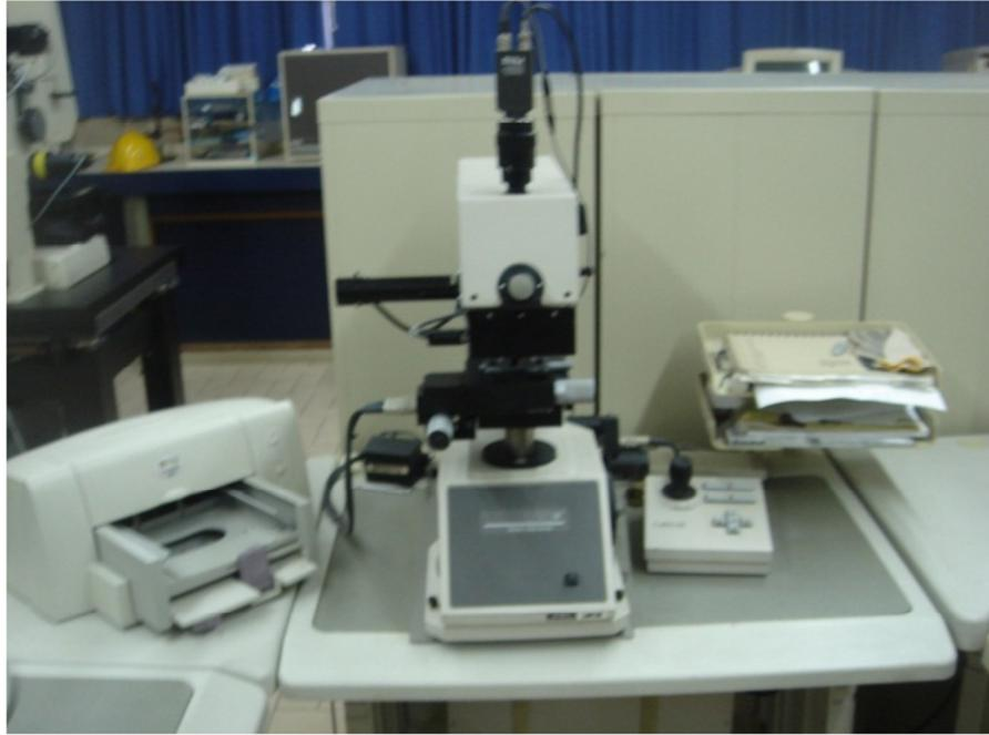
**Fig. 15 Microdurómetro LECO AI3001**
