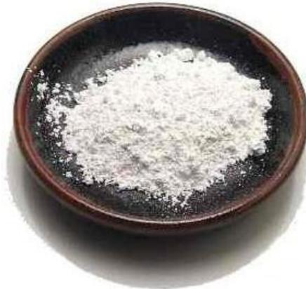
Fig. 2.2 Hidróxido de Calcio (Productos y servicios para la industria del agua latinoamericana)
