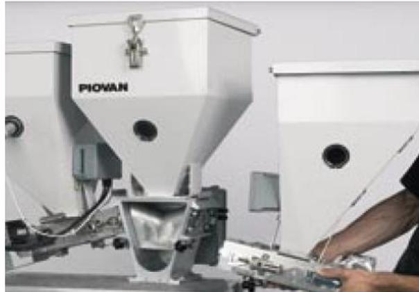
Fig. 2.10 Dosificador volumétrico serie MDP. Piován (Dosificadores volumétricos para granulados plásticos-PIOVAN)
