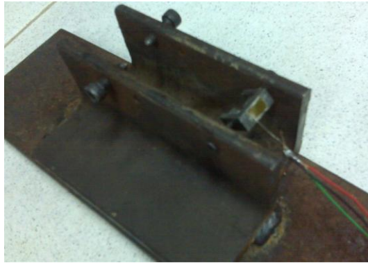
Figura 3.12. Montaje donde se realizo la medición con las galgas.
