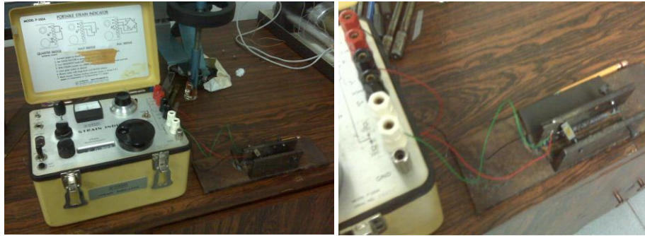
Figura 3.14. Conexión de la galga al transductor para un cuarto de puente sin compensación
