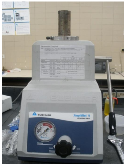
Figura N° 2.8. Embudidora marca BUEHLER modelo Simpliment.
