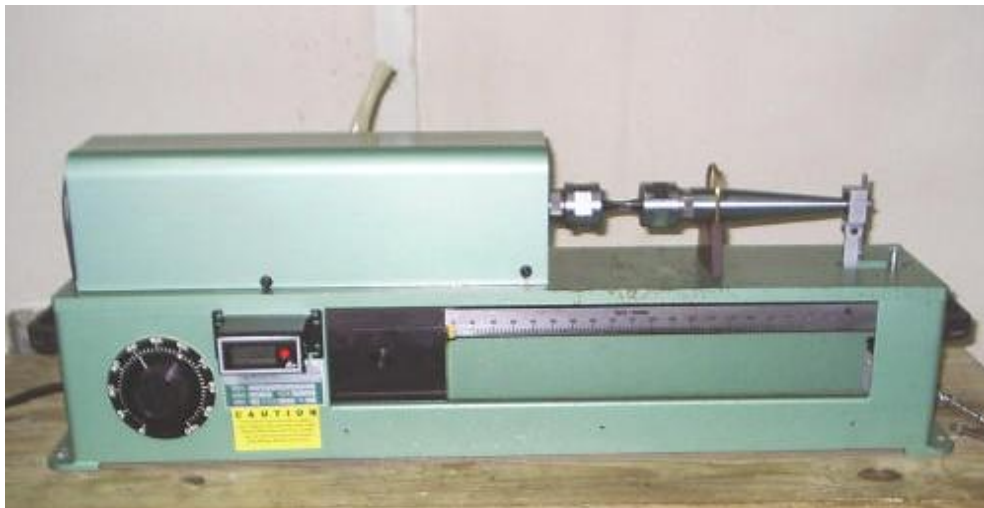
Figura N° 2.4. Máquina de flexión rotativa marca FATIGUE DYNAMICS, modelo RBF-200.
