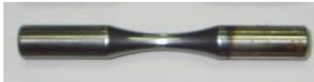
Figura N° 2.3. Probeta de acero AISI 4340 recubierta con CrN.
