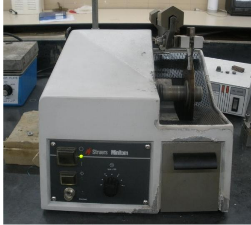
Figura N° 2.6. Cortadora de disco de diamante marca STRUERS modelo MINITOM.
