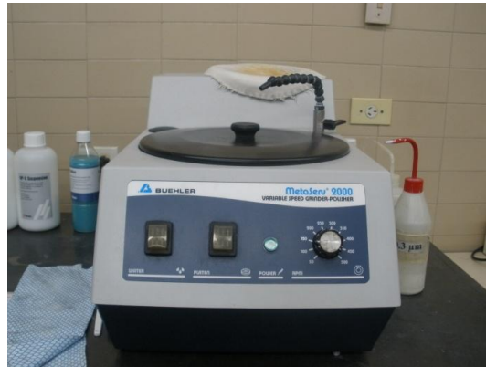
Figura N° 2.9. Pulidora marca BUEHLER modelo METASERV 2000 variable “speed grinder-polisher”
