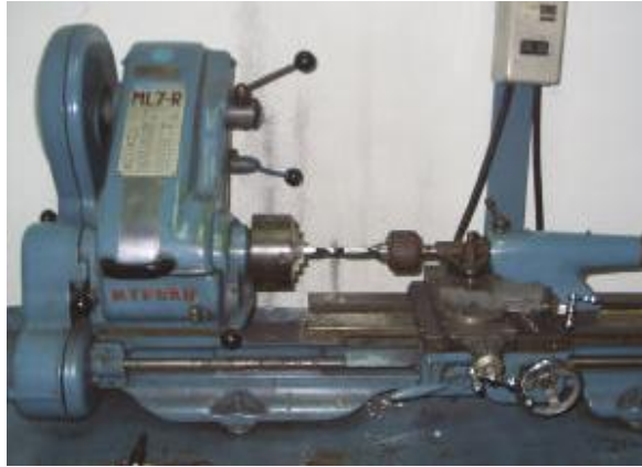
Figura N° 2.2. Torno marca Myford con plato de mordaza graduable.
