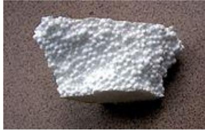
Figura 4. 6 “Material espuma de poliestireno”
