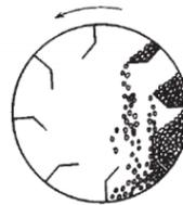
Figura 2. 18 “Secador rotatorio”
