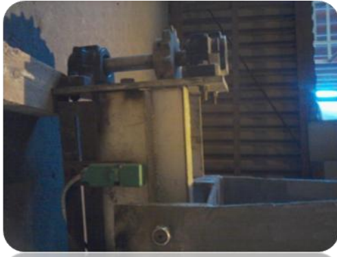
Fig. 5.45. Sensor Inductivo Limitador de Carrera Superior del Carro de Transporte
