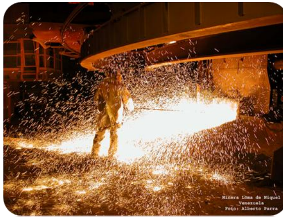
Fig. 2.3. Colada de Metal en el Horno de Reducción L2
