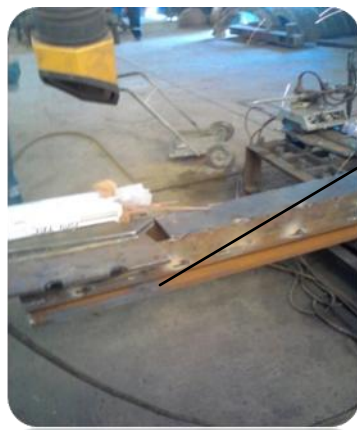
Fig. 5.19. Soldadura Intermitente Perfil UPN 80
