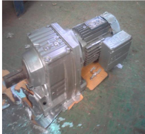
Motorreductor cubierta con una película de pintura de alta temperatura
