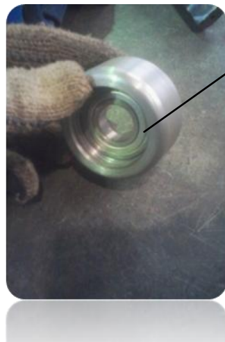
Fig. 5.33. Rueda Guía Ensamblada con el Rodamiento
