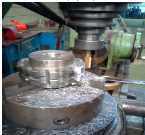
Fresado del perfil de los dientes de la Rueda dentada
