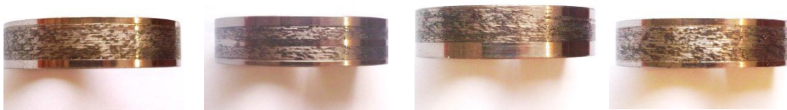
Fig 4.18: Fotografías de la superficie desgastada de los anillos AISI D2 para todas las categorías de carga y velocidad
