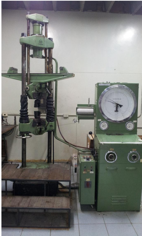
Figura 16: Máquina de ensayos universales, ensayo de tracción.
