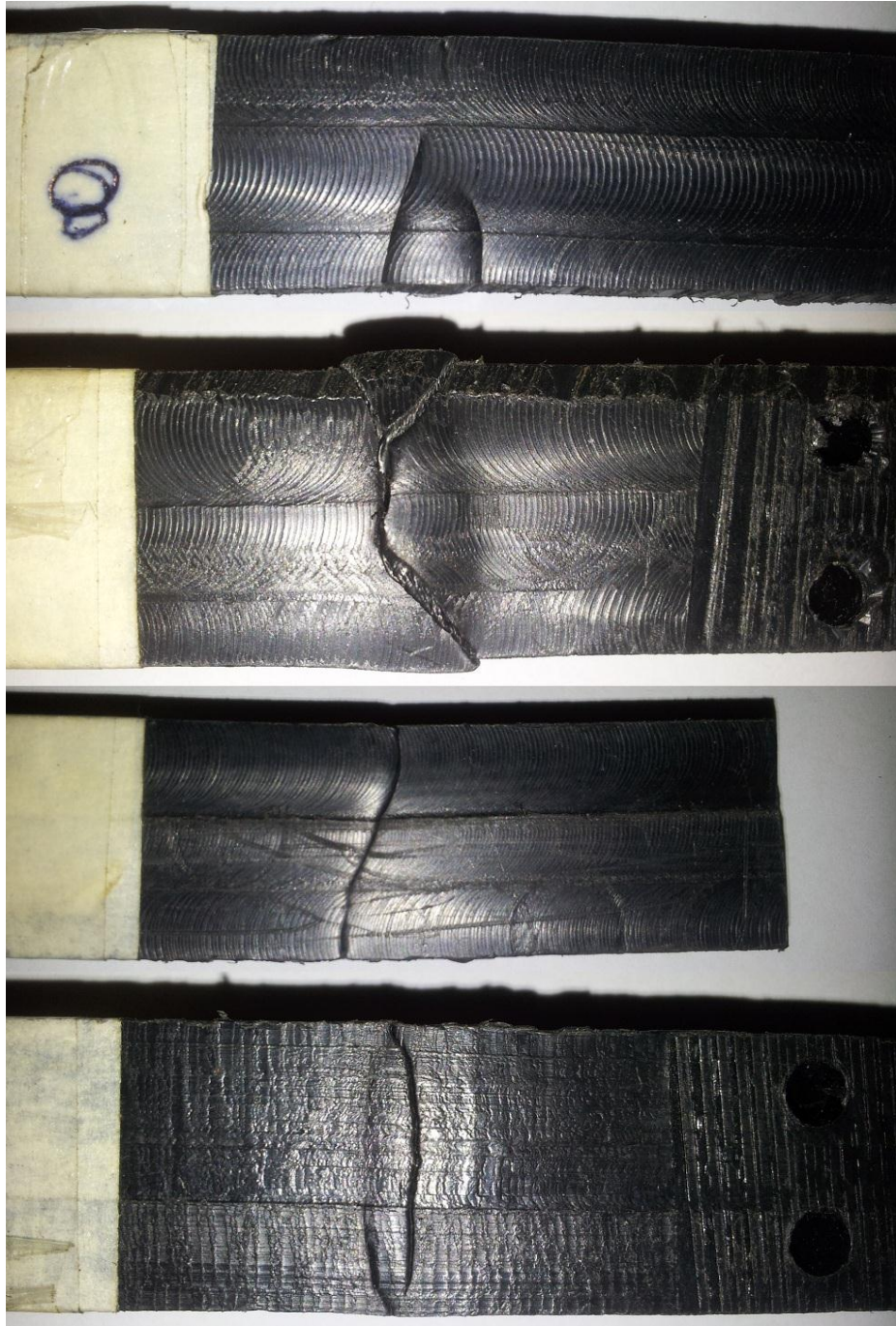
Anexo 8: Probeta de fatiga después del ensayo.
