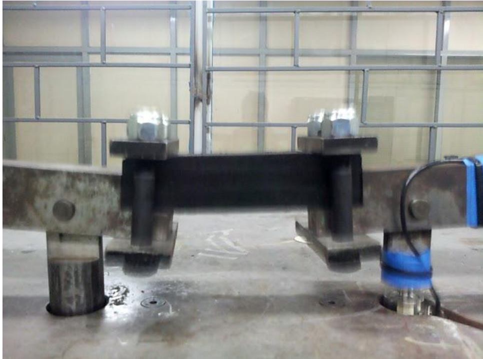
Anexo 5: Ensayo de fatiga en vivo (foto de alta velocidad).
