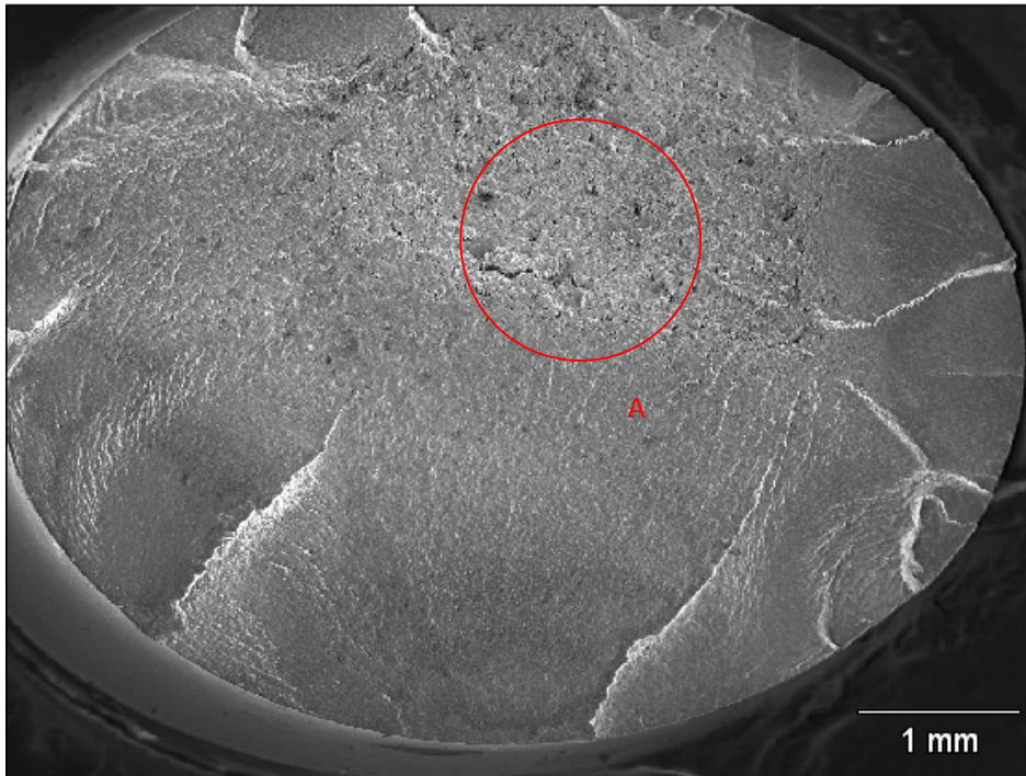
Figura 4.3 Fatiga corrosión AISI 4340 + Balinit Helica S=574 MPa Nf= 97300
