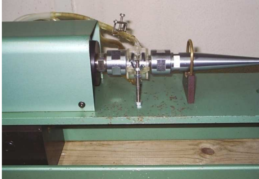
Figura 2.16. Máquina de flexión rotativa con dispositivo para ensayos en ambiente corrosivo.
