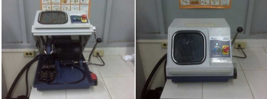
Figura 2.21. Cortadora de disco abrasivo marca BUEHLER modelo SAMPLMET 2.
