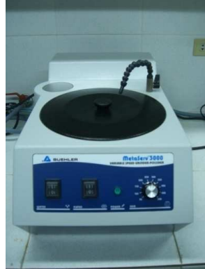
Figura 2.6. Pulidora-lijadora de velocidad variable Metaserv 3000, marca Buehler.
