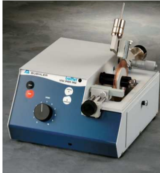
Figura 2.23. Cortadora de baja velocidad marca BUEHLER modelo ISOMET LOW SPEED SAW.
