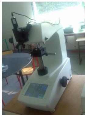
Figura 2.11. Máquina de ensayos de Dureza marca TESTWELL, modelo FLC 50V.
