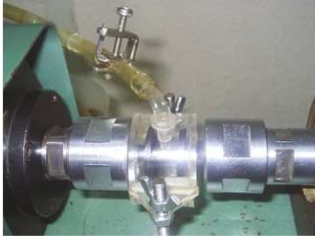
Figura 2.17 Cápsula para ensayos en ambiente corrosivo acoplada a máquina de flexión rotativa.
