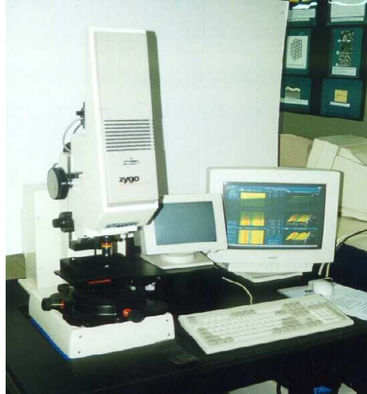
Figura 2.14. Equipo de perfilometría, marca ZYGO, modelo NEW VIEW 200
