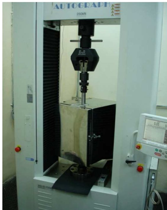
Figura 2.9. Máquina para Ensayos Mecánicos marca Shimadzu, modelo AG-IS.
