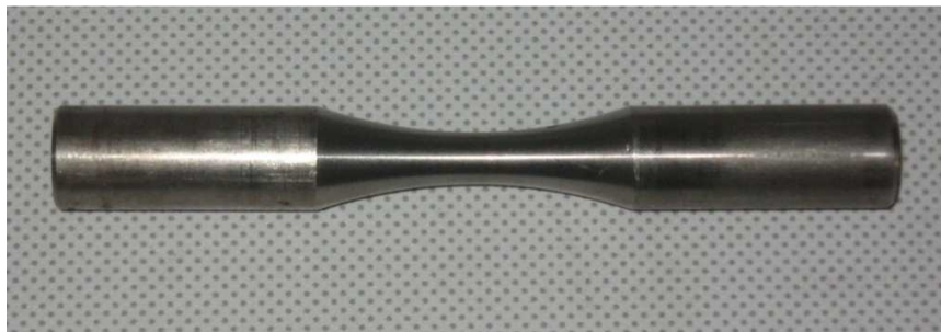
Figura 2.3. Probeta para ensayos de fatiga en flexión rotativa según la norma ASTM E 606 [22] .
