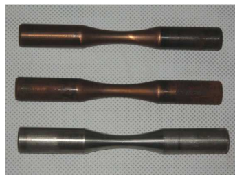
Figura 2.8. Dos probetas de acero AISI 4340 recubiertas con Balinit Helica y una (inferior) sin recubrir. Se puede ver la diferencia de color una vez depositado el recubrimiento.
