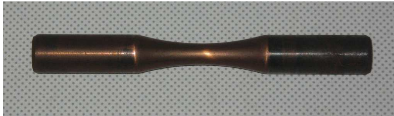
Figura 2.7. Probeta de acero AISI 4340 recubierta con Balinit Helica.
