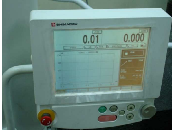
Figura 2.10. Panel de Control Digital de La Máquina de Ensayos, marca Shimadzu, modelo AG-IS.
