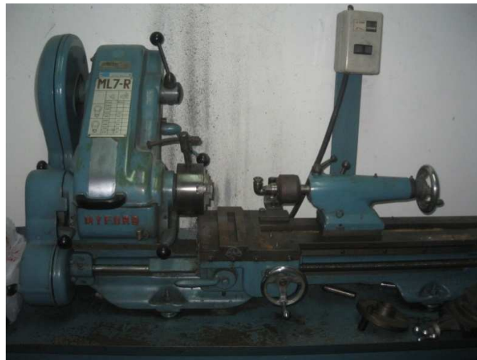
Figura 2.4. Torno marca Myford con plato de mordaza graduable.
