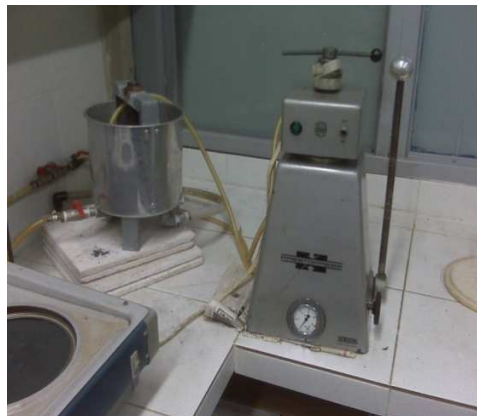
Figura 2.24. Embutidora PRESTOSPRESS marca STRUERS con sistema de refrigeración.
