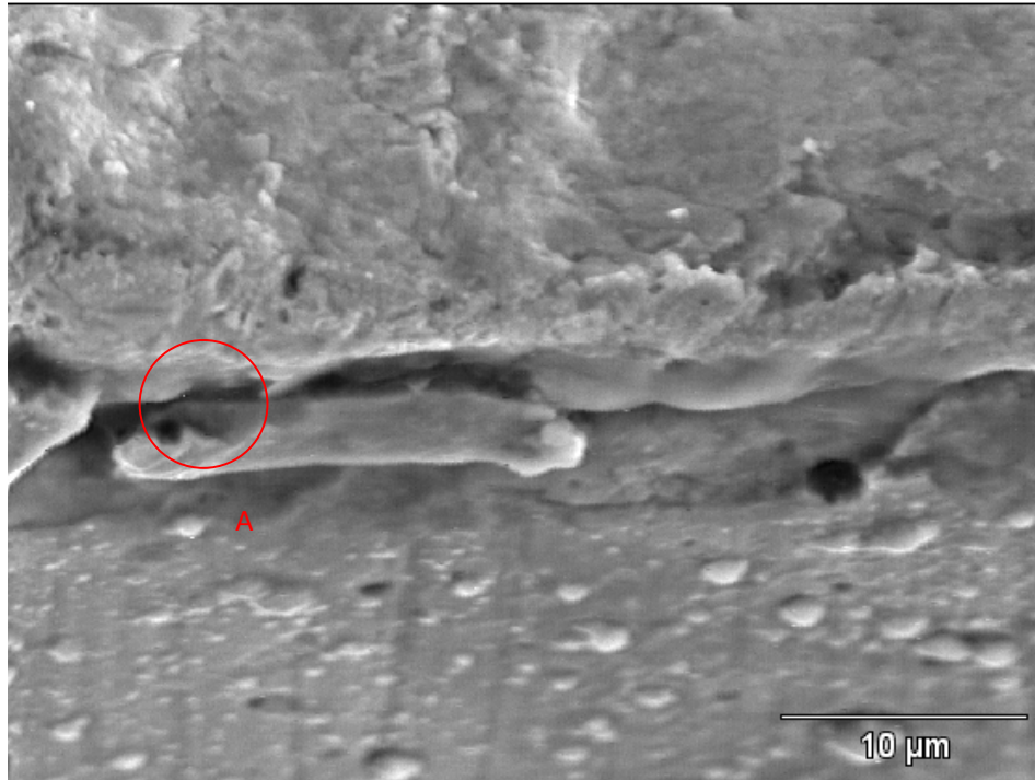
Figura 4.6 Fatiga corrosión AISI 4340 + Balinit Helica S=574 MPa Nf= 97300
