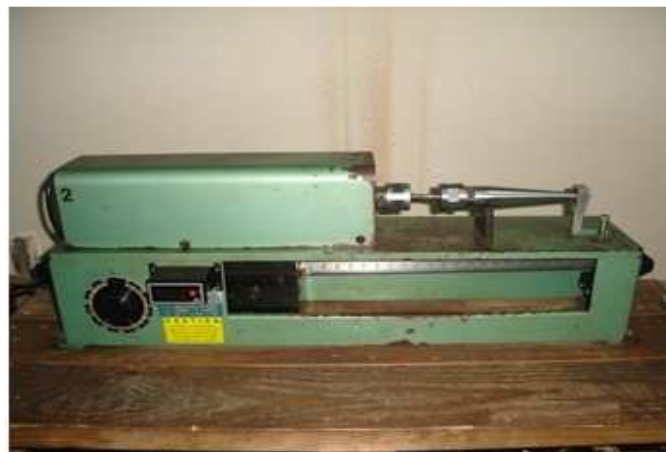
Figura 2.15. Máquina de flexión rotativa marca FATIGUE DYNAMINS, modelo RBF-200.
