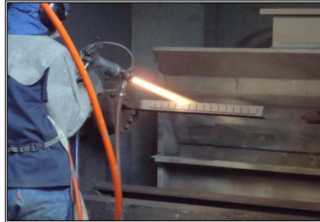
Fig. 3.8. Deposición de recubrimiento con pistola Whitco Hypersonic JP-5000.
