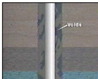
**Fig.3-8. Cementación primaria deficiente<sup>[4]</sup>**
