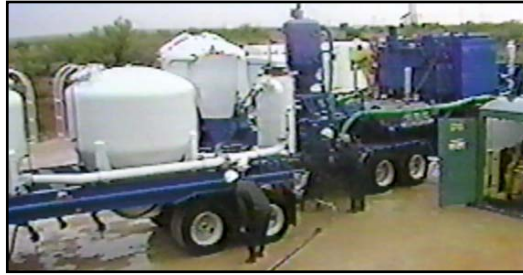
Fig.A-2. Camión Cementero Típico con Tanques de Desplazamiento
