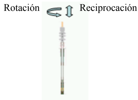
Fig.A-13. Movimiento de la tubería
