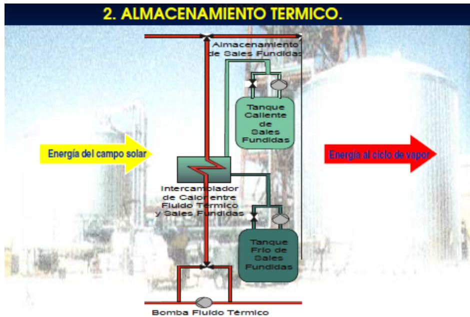
Fig.51 Sistema de almacenamiento térmico
