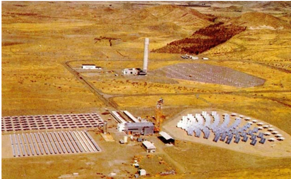
Fig39 Plataforma Solar de Almería, con las centrales DCS (colectores cilíndricos-parabólicos) y CRS (tipo torre central), al fondo la CESA-1, también de torre central.
