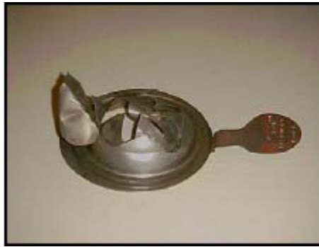
Figura. 2.46. Disco de ruptura luego de haber actuado.
