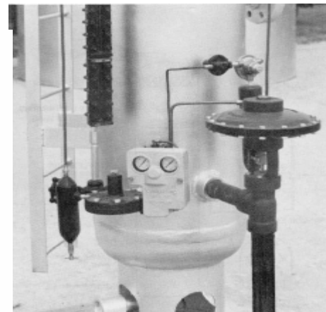
Figura. 2.9. Controlador de nivel de líquido sin flotador y válvula de control tipo diafragma. [7]
