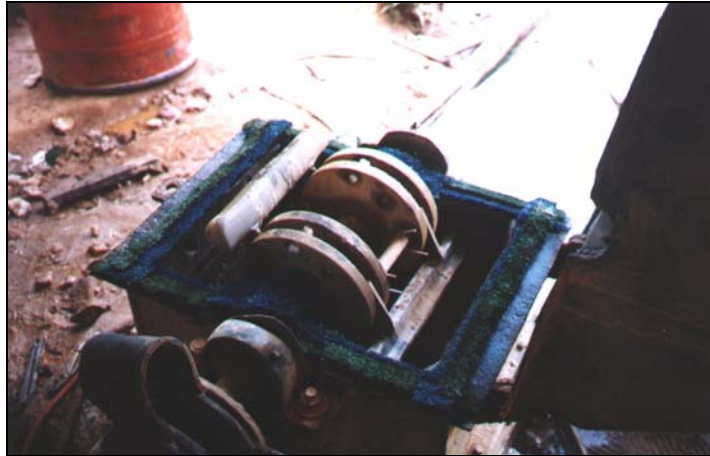
Figura 4.18 Fotografía de la vista interna del molino de martillo.
