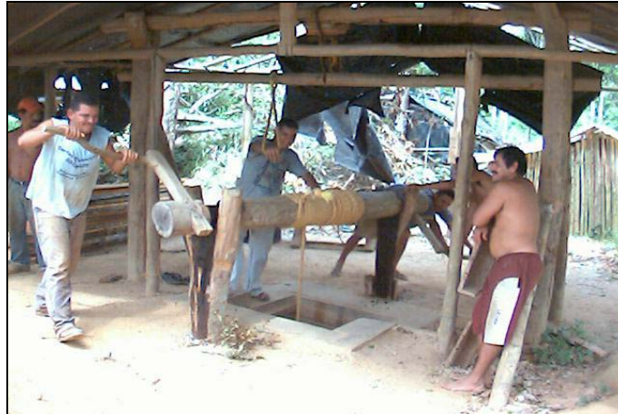
Figura 4.12 Fotografía de la machina o torno manual.
