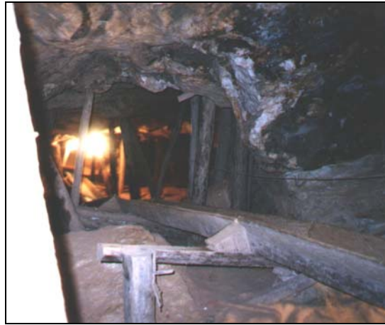
Figura 4.6 Fotografía del sostenimiento con puntales de madera en la pequeña minería de oro proyecto Hoja de Lata. Fuente: Propia.
