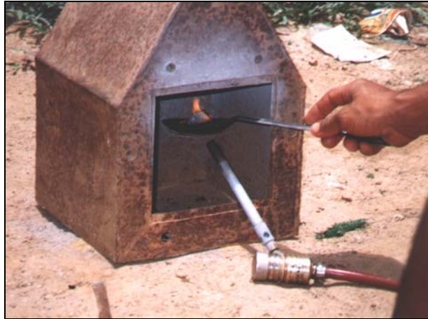
Figura 4.22 Fotografía de la separación del oro y mercurio por medio de llama directa. Fuente: Propia.
