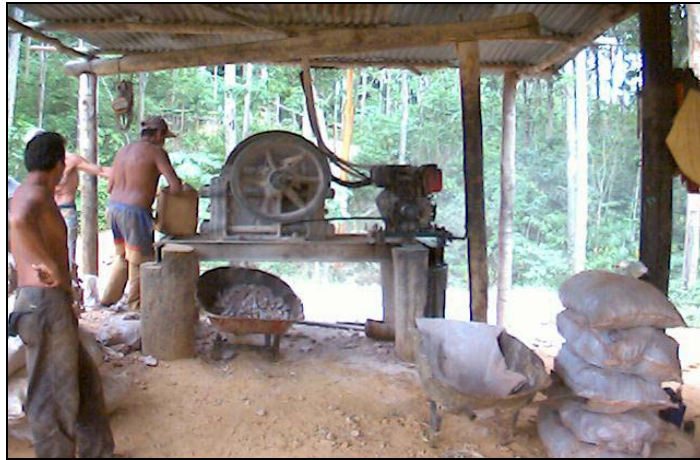
Figura 4.16 Fotografía de la trituración de la mena aurífera mediante trituradora de mandíbula. Fuente: Propia.
