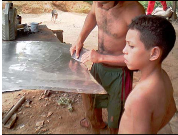
Figura 4.20 Fotografía del raspado de plancha con espátula.
