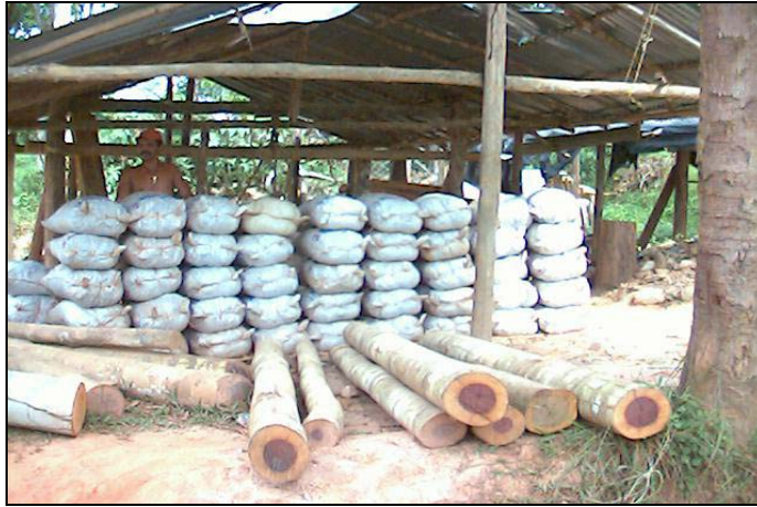
Figura 4.14 Fotografía del apilamiento y almacenamiento de los sacos de mena, esto se realiza cerca de los pozos. Fuente: Propia.
