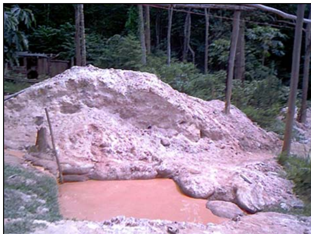
Figura 4.23 Fotografía de una de las tanquillas o lagunas de sedimentación.
