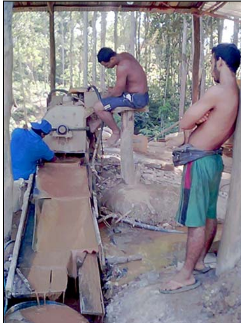
Figura 4.19 Fotografía de la molienda del material y planchas amalgamadoras.
