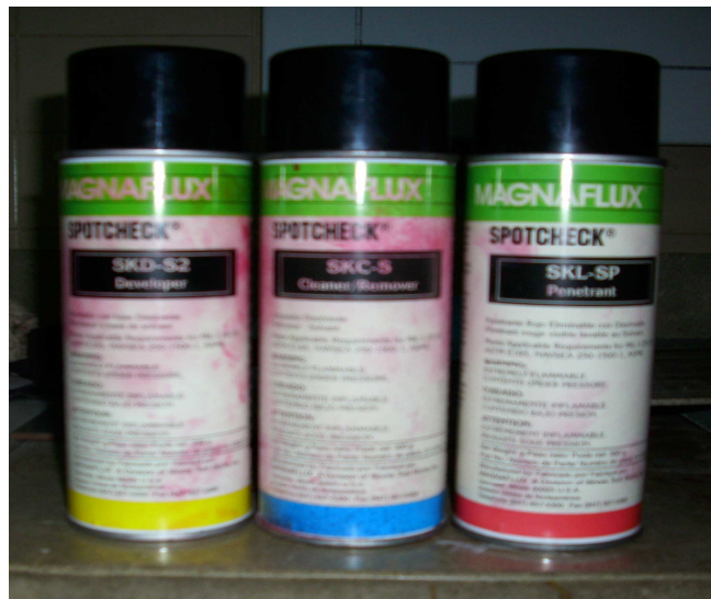
Figura 2.13.- Kit de líquidos penetrantes.
