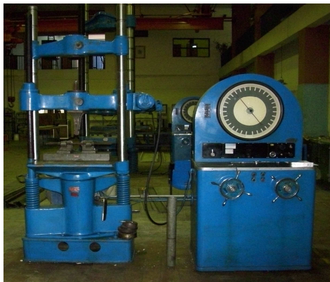
Figura 2.23.- Máquina Universal de Ensayos BALDWIN Tate-Emery Load Indicator, utilizada en los ensayos de doblez de la junta soldada.
