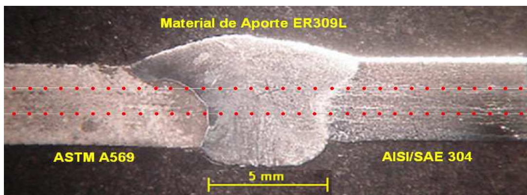
Figura 2.17.- Esquema del barrido de microindentaciones realizado en la junta soldada.
