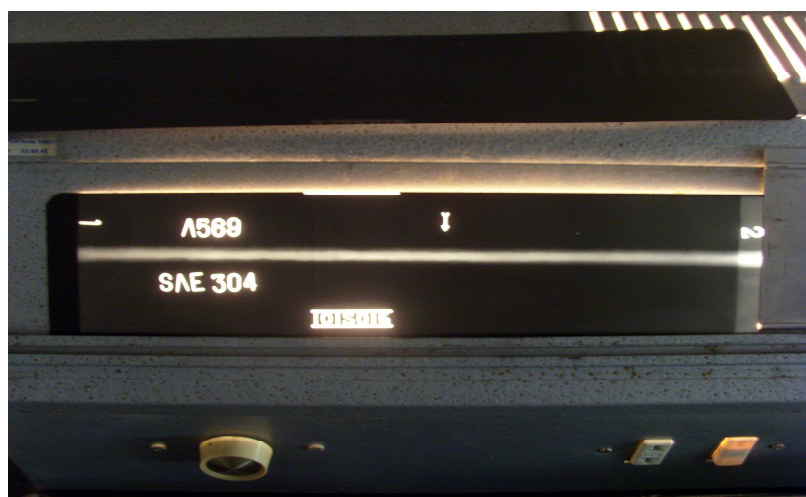
Figura 3.30.- Radiografía del cupón soldado observada en la pantalla fluoroscópica.
