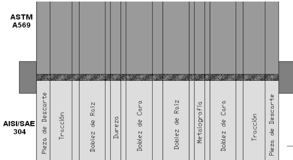
Figura 2.12.- Cupón de prueba y distribución de las probetas para los ensayos requeridos.
