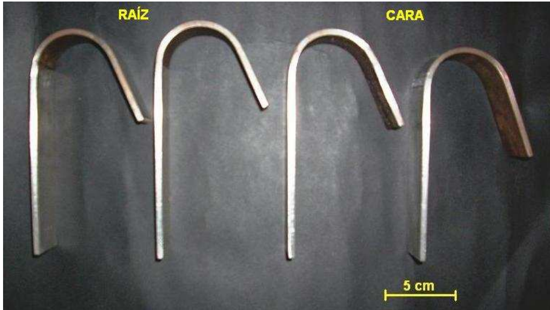
Figura 3.39.- Conjunto de probetas de uniones disímiles de Acero Inoxidable Austenítico AISI/SAE 304 y ASTM A569, soldadas con un electrodo ER309L (vista lateral).
