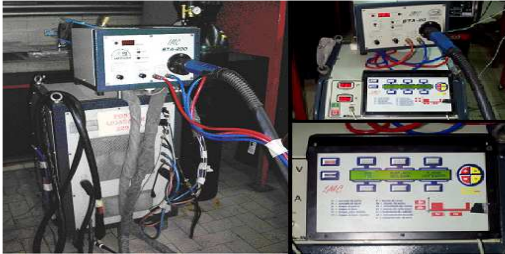
Figura 2.10.- Fuente de energía MTE DIGITEC 450, con su panel de control y sistema de alimentación.
