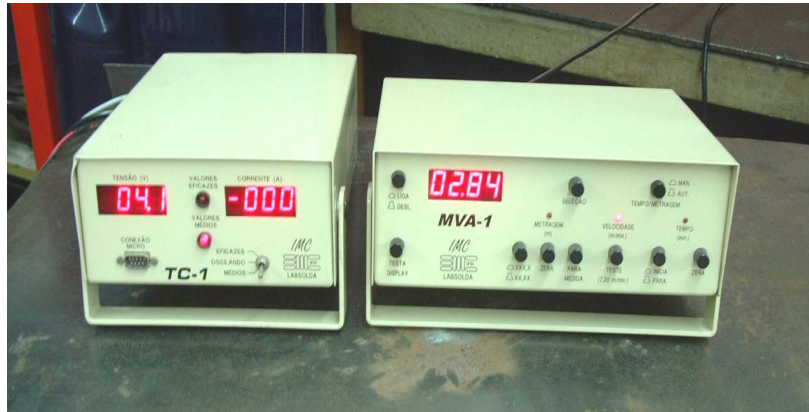
Figura 2.11.- Equipos auxiliares. Equipo TC-1, para medición de voltaje, corriente media y eficaz. Equipo MVA-1, para medición de velocidad de alimentación del alambre.
