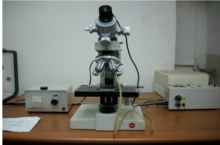
Figura 2.18.- Microdurómetro marca Leitz Wetzlar, modelo 7520 Metallux, utilizado en el ensayo de microdureza de la junta soldada.
