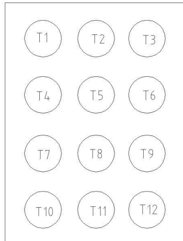
Fig.7.21 Diagrama de los Bornes de los motores según NEMA
