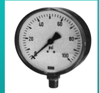
Manómetro de tubo Bourdon
