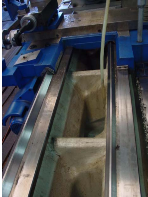
Fig 2.17.1. Bancada de un torno
