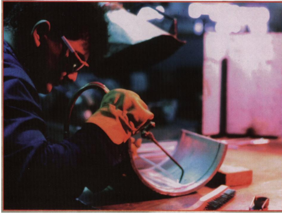
Figura 4.2: Reparación del cojinete N° 2.
