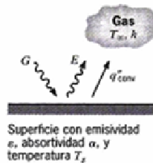
Fig. 2. 13.- Transferencia de calor por radiación entre una superficie y el ambiente.
