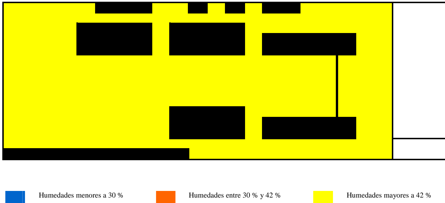
Fig. 4. 4.- Esquema de humedades relativas medidas en la S/E Transfo-rectificadora Petare.
