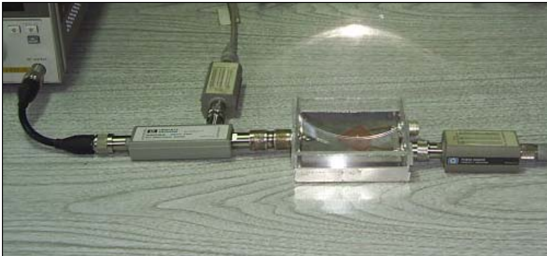
Figura 3.11. Implementación del esquema de conexión para la medición de los parámetros S.
