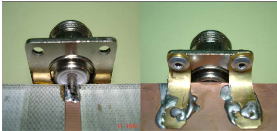
Figura 3.2. Soldadura de estaño realizada para unir los conectores al divisor.
