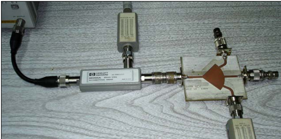
Figura 3.9. Implementación del esquema de medición de los parámetros S. Divisor 1:3.
