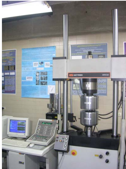
Figura 1.1 Máquina universal de ensayos mecánicos Instron 8502, ubicada en el Laboratorio Nacional de Caracterización de Propiedades Mecánicas, Desgaste y Corrosión de Materiales
