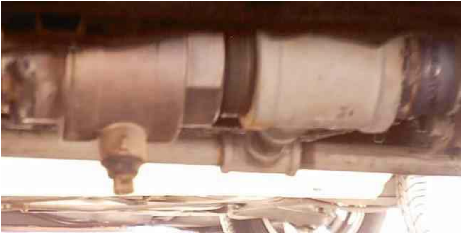
Anexo 24: Sistema de desvío de los gases de escape (válvula y Te). Fuente: Propia.
