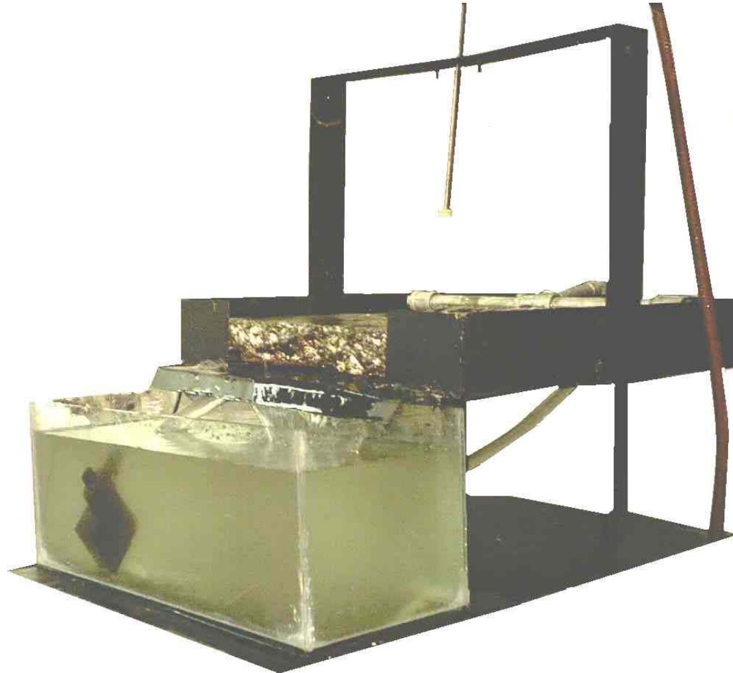
Anexo 10: Banco de prueba (estudio de presión mínima de gases de escape). Fuente: Propia
