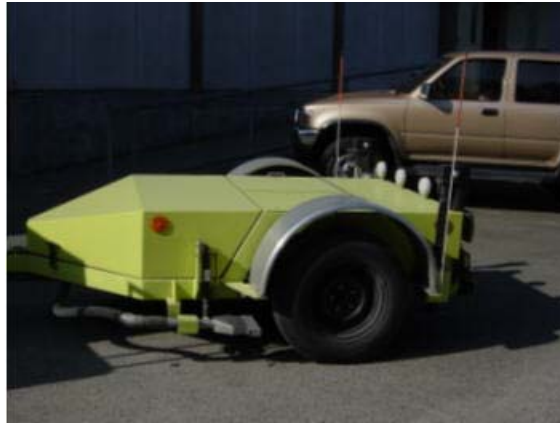
Figura 5-1: Banco de prueba para ensayo de fricción de rueda bloqueada (locked wheel skid test). Fuente: WSDOT.
