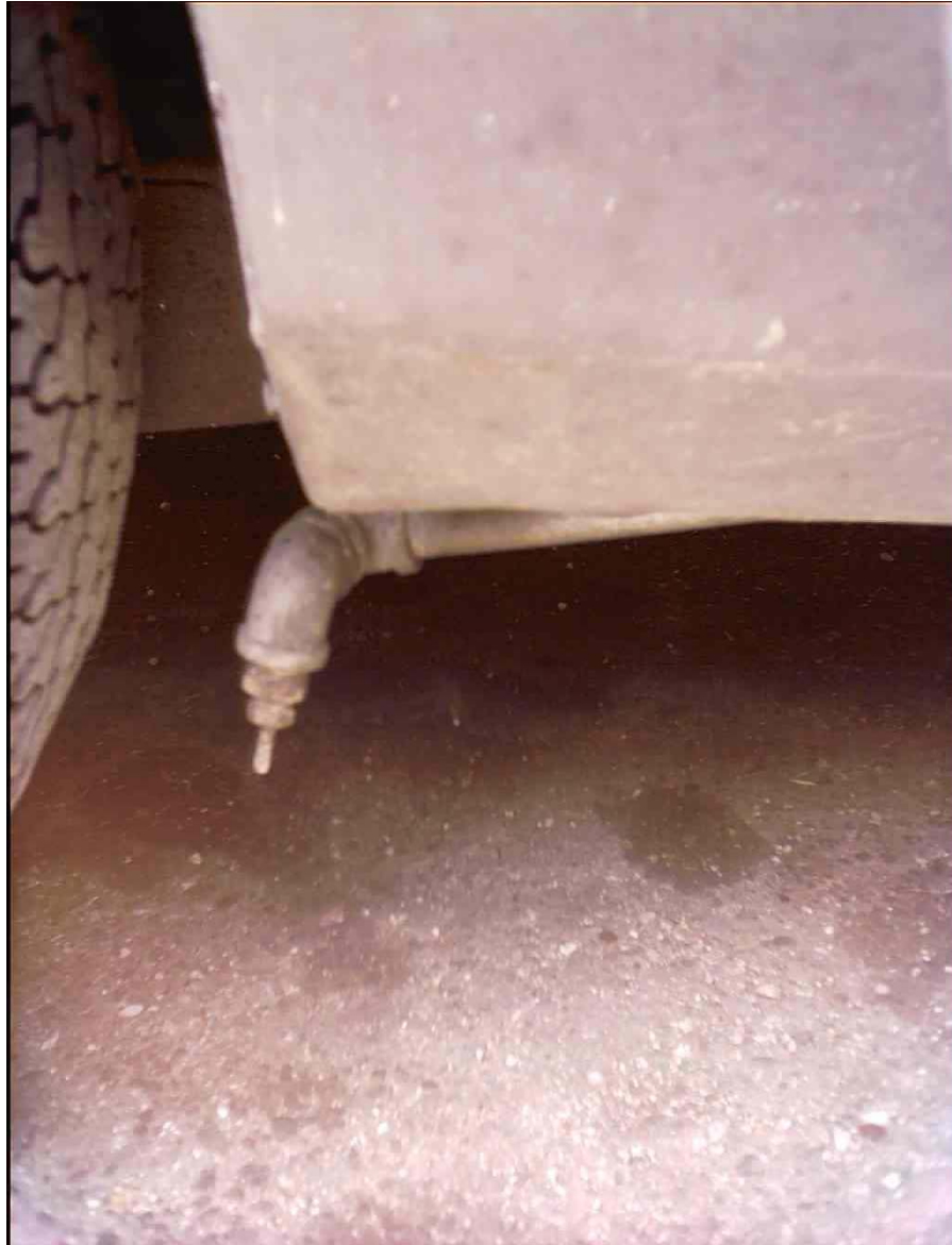
Anexo 26: Sistema de desvío de los gases de escape (boquilla). Fuente: Propia.
