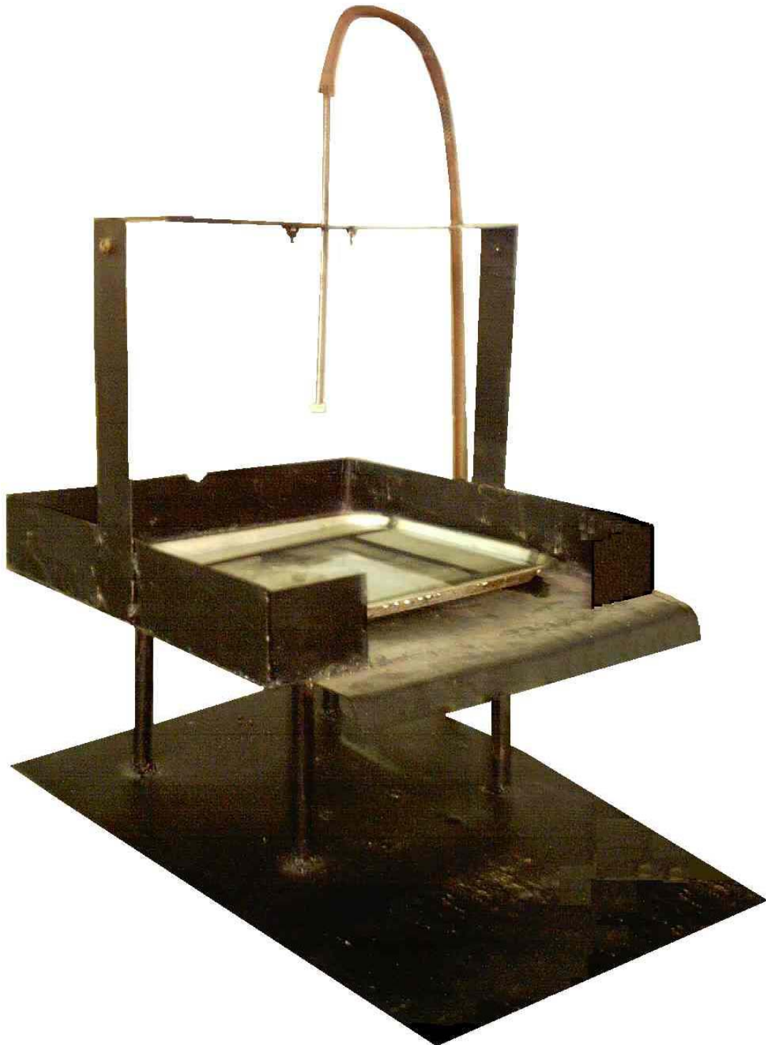
Anexo 2: Banco de prueba (estudio de geometría de un chorro de choque). Fuente: Propia
