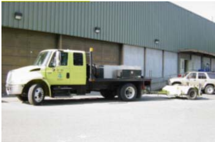
Figura 5-2: Equipo completo para la prueba de fricción de rueda bloqueada. Fuente: WSDOT.
