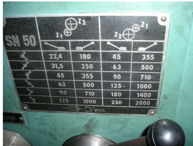
Placa velocidades del torno Fuente: TOS TRENCIN
