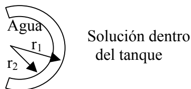
Figura N° 5.40 Representación de la tubería del intercambiador
