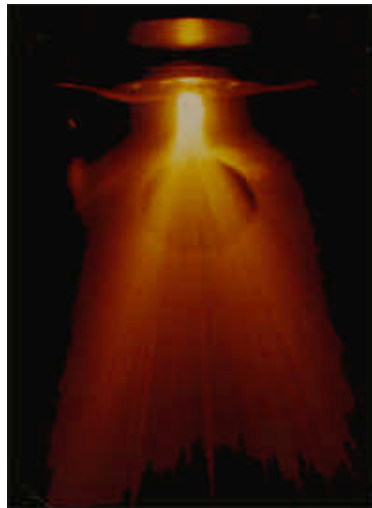
Figura 1.7 Atomización por chorro de gas (tomado del INEEL)
