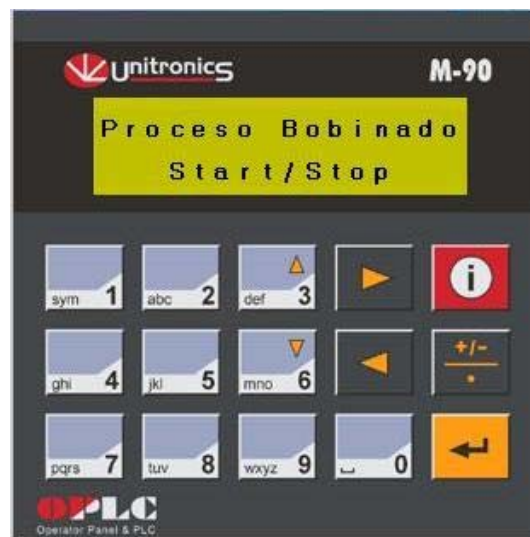
Figura 6.12 Arranque o parada del proceso
