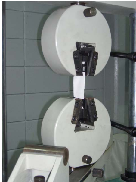
Anexo 3.6 Montaje de las probetas de papel
