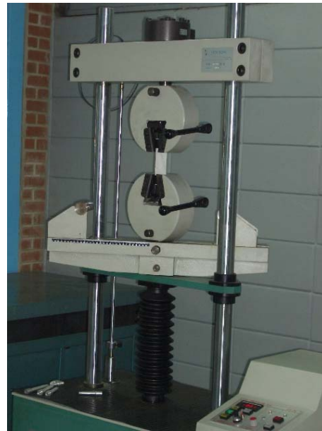
Anexo 3.6 Montaje de las probetas de papel
