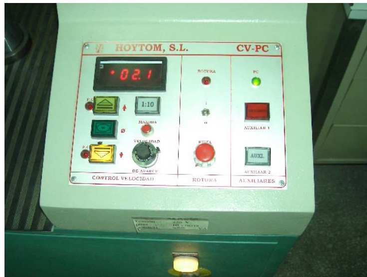
Anexo 3.8 Panel de control de la máquina de ensayos universal HOYTOM
