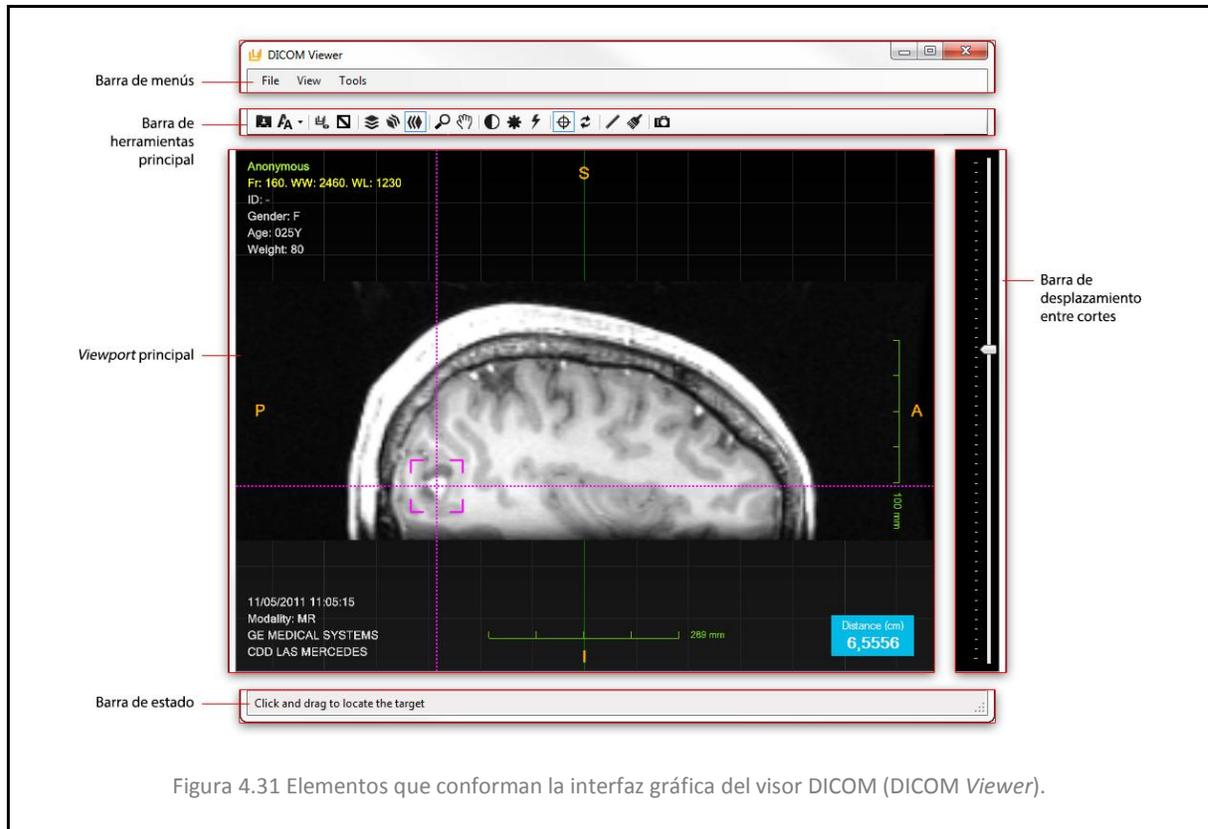
Figura 4.31 Elementos que conforman la interfaz gráfica del visor DICOM (*DICOM Viewer*).
