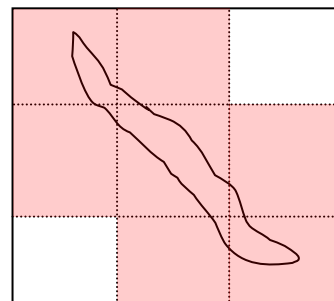
Figura 5.5: Comparativa entre utilizar una subdivisión de menor tamaño contra una de mayor tamaño, observe que para este ejemplo usando bloques de mayor tamaño se necesita 7/9 del volumen y en el de menor tamaño se necesita 1/3 del volumen solamente.
