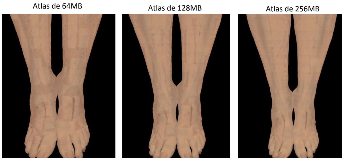
Figura 5.6: Aquí se compara el volumen utilizando distintos tamaños del Atlas. Para esta prueba se utilizaron bloques de tamaño 33^3
