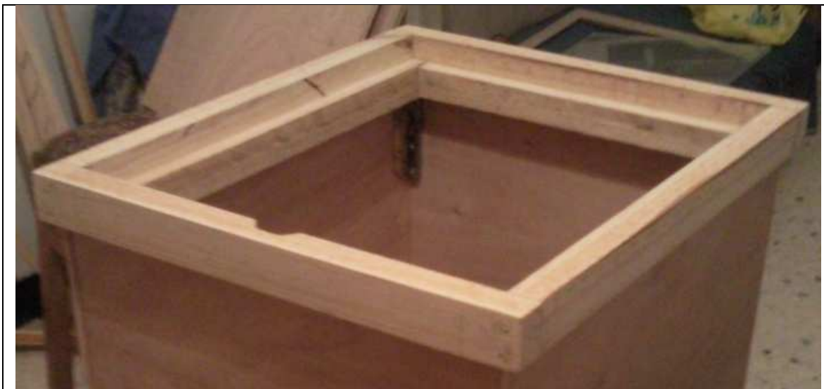
Figura 4.3 – Marco externo que unifica el marco IR, el acrílico y el vidrio esmerilado
