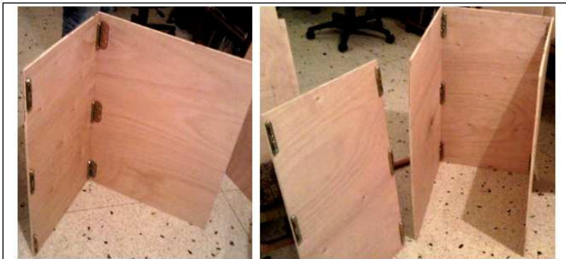
Figura 4.5 – Vista de las tablas ensamblables de soporte del tope de la mesa
