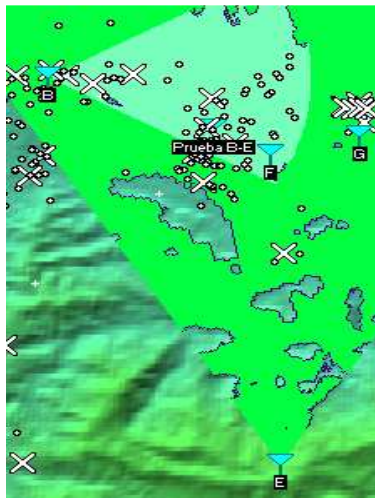
Fig. 51.- Simulación de interferencia en el Nodo B CH-2 debido al Nodo E CH-2
