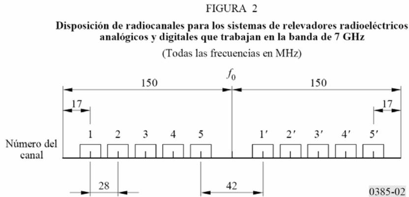
**2** Todos los radiocanales de ida deben estar en una mitad de la banda y todos los radiocanales de retorno en la otra mitad.
