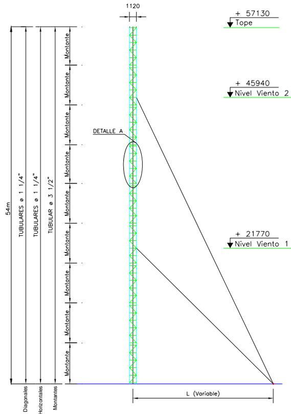
**ESQUEMA DE LA ESTRUCTURA**
