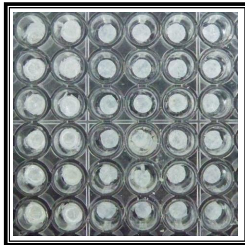
Figura 26. Placa ELISA con el sol-gel obtenido en la primera metodología.
