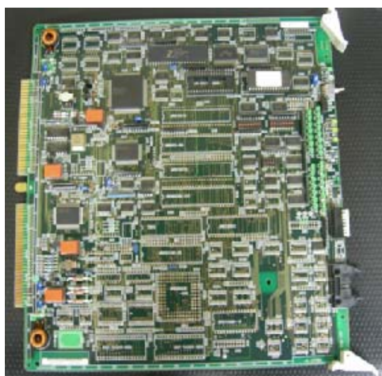
PA-30DTS (Tarjeta interfaz de E1 para la PBX NEC)
