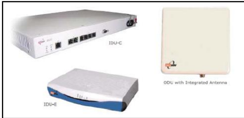
Figura N° 5.9: Radio WinLink 1000 para bandas de frecuencias de 2.4 y 5.8 GHz
