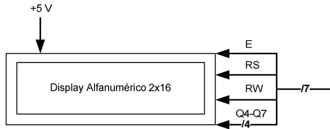
Figura 12: Conexiones de la Pantalla LCD para 4 bits de puerto.
