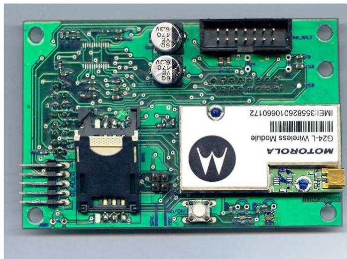
Figura 14: Circuito Impreso del Módulo de Comunicación GSM.
