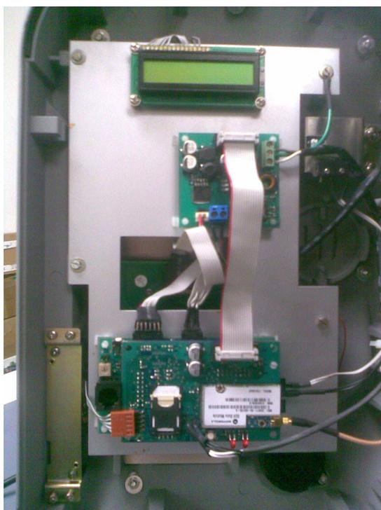
Figura 7: Distribución interna de tarjetas de circuito impreso del teléfono público
