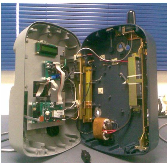
Figura 6: Distribución interna de elementos del teléfono público
