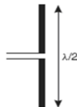
Figura 1.9: Antenna a dipolo.
