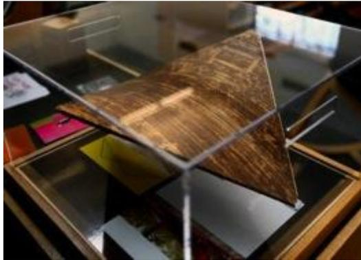
Figura 82. En la biblioteca de la Escuela de Diseño de la NCSU, se exhibe la maqueta original elaborada por Catalano que sirvió para modelar la solución estructural de la Casa Raleigh.
