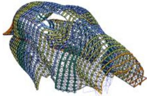
Figura 221. Malla diseñada por Gehry para la cúpula de DZ Bank, en Berlín.
