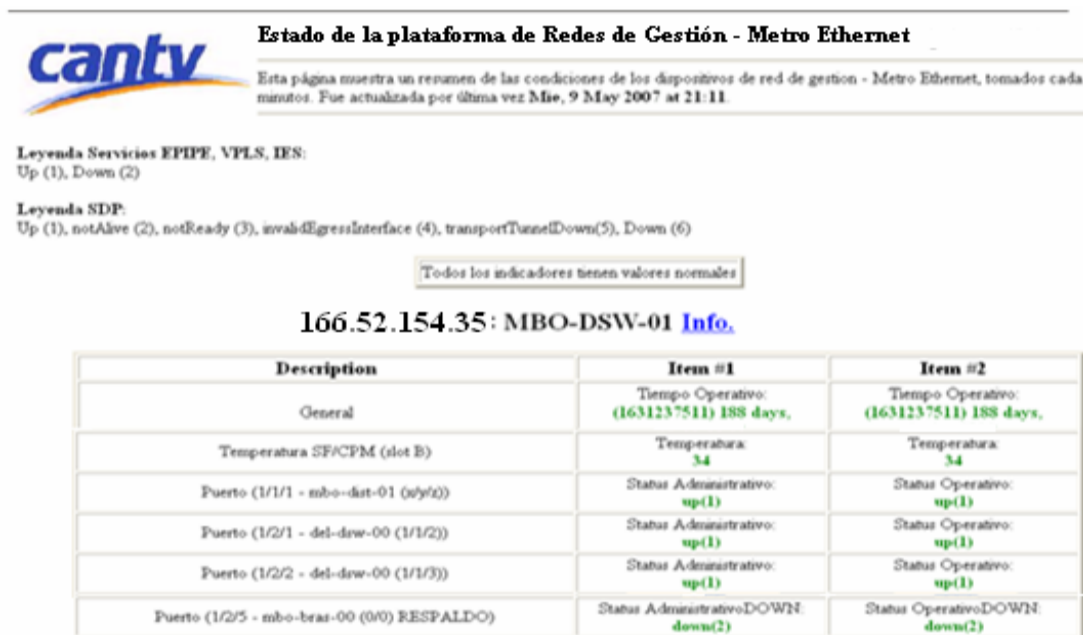
Figura N° 14. Estado de operatividad de las interfaces de interconexión entre switches Metro Ethernet
