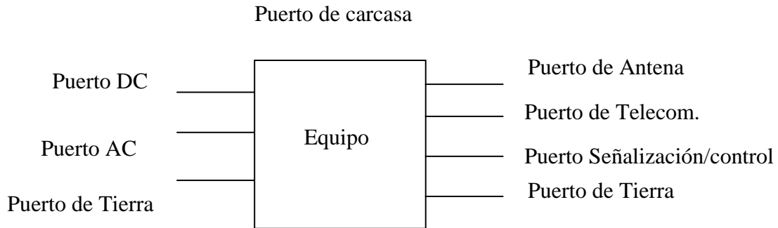
Figura 1. Puertos de un equipo de Telecomunicaciones
